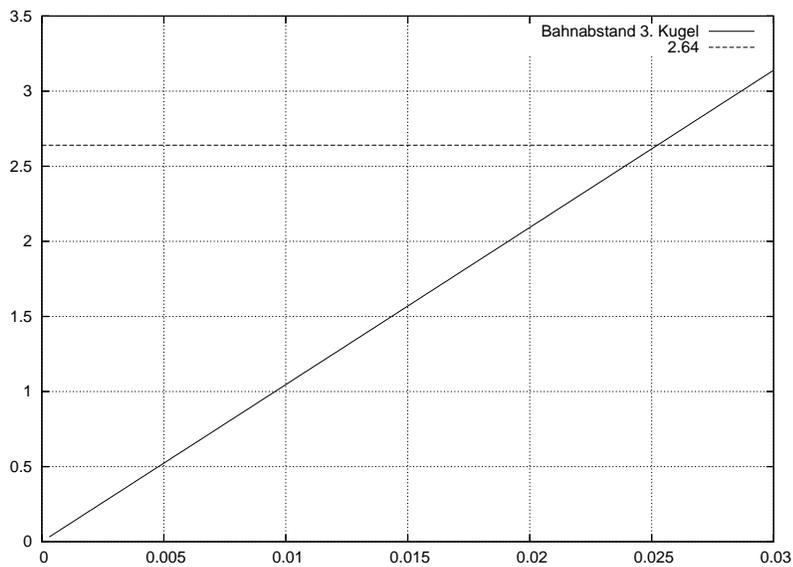
Abbildung 6: Bahnabweichung der dritten Kugel in cm abgetragen über der Winkelabweichung der ersten Kugel in Grad.
