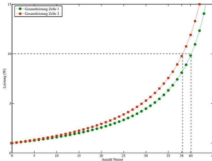
**Schritt 2** Die tatsächlichen benötigten Sendeleistungen  $p_1$  und  $p_2$  pro Verbindung in Zelle 1 und Zelle 2 zur Bedienung von  $n_1$  bzw.  $n_2$  Elfen lassen sich nur unter genauer Beachtung der Störungen zwischen den Zellen bestimmen.
